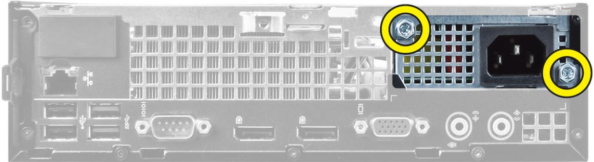
5. Faça deslizar a fonte de alimentação para dentro e retire-a do computador.
