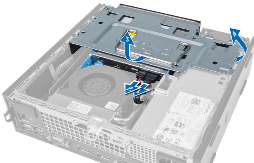
4. Desligue os cabos de dados e de alimentação da parte posterior da unidade de disco rígido e retire a caixa de unidades do computador.
