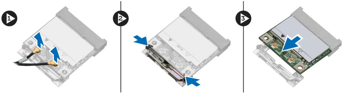
4. Retire o cabo da antena do computador.
