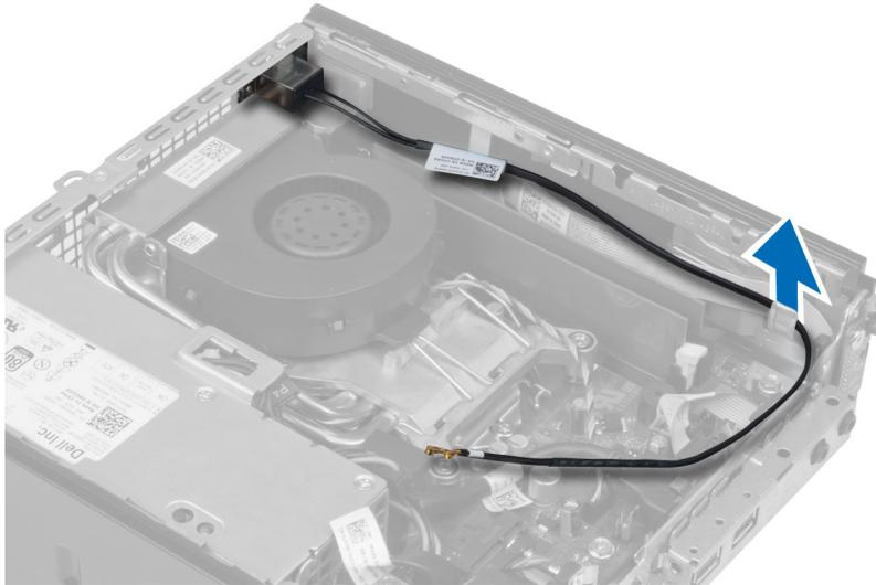
5. Retire os parafusos que fixam o disco da antena ao conector. Puxe o disco da antena do computador.
