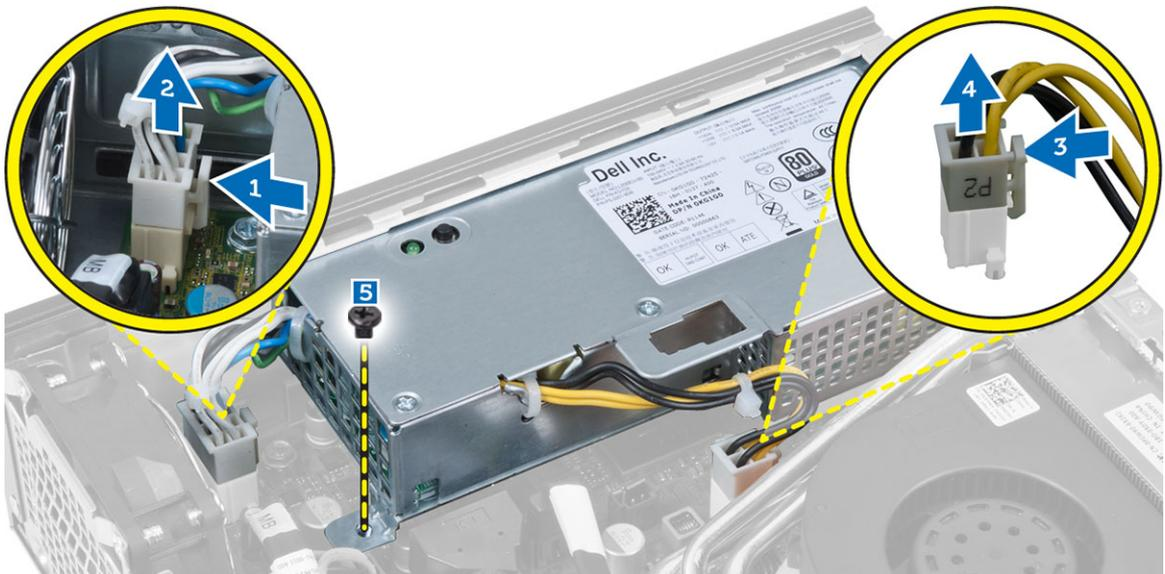
4. Retire o parafuso que fixa a fonte de alimentação ao chassis.
