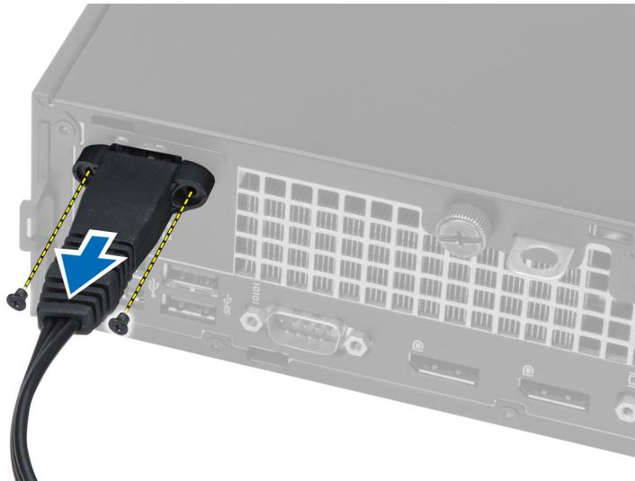
6. Deslize e retire o conector da antena do computador.
