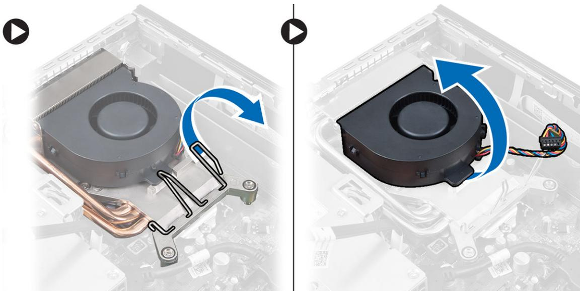
5. Desaperte os parafusos integrados e levante o conjunto do dissipador de calor e retire-o do computador.
