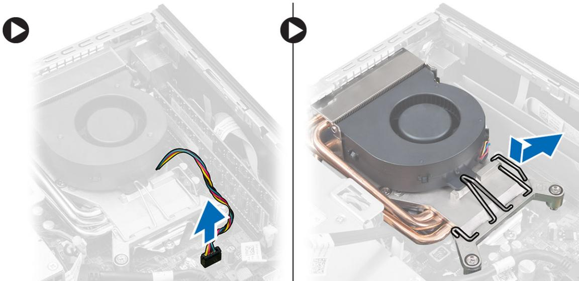
4. Vire a alavanca de desbloqueio e levante a porção superior da ventoinha.
