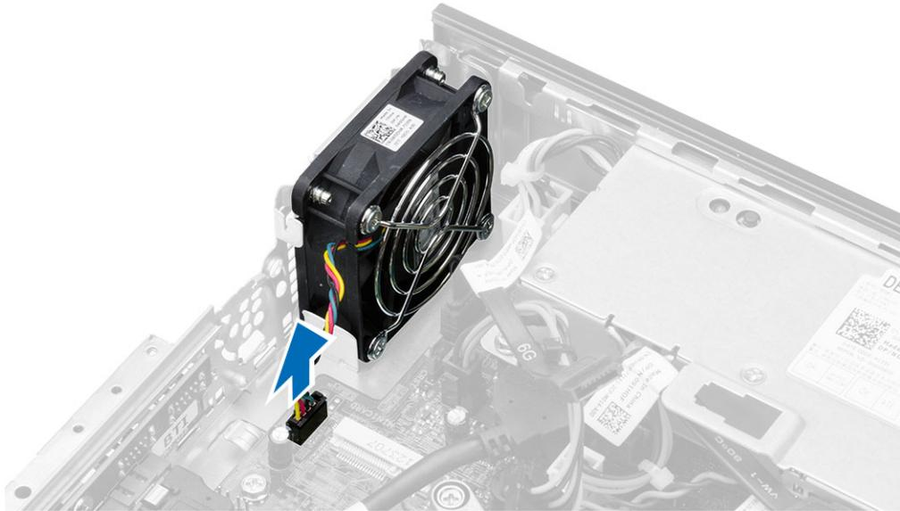
4. Retire os parafusos que fixam a ventoinha ao chassis.
