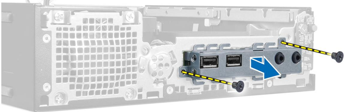
5. Retire os parafusos que fixam o painel de E/S ao suporte.
